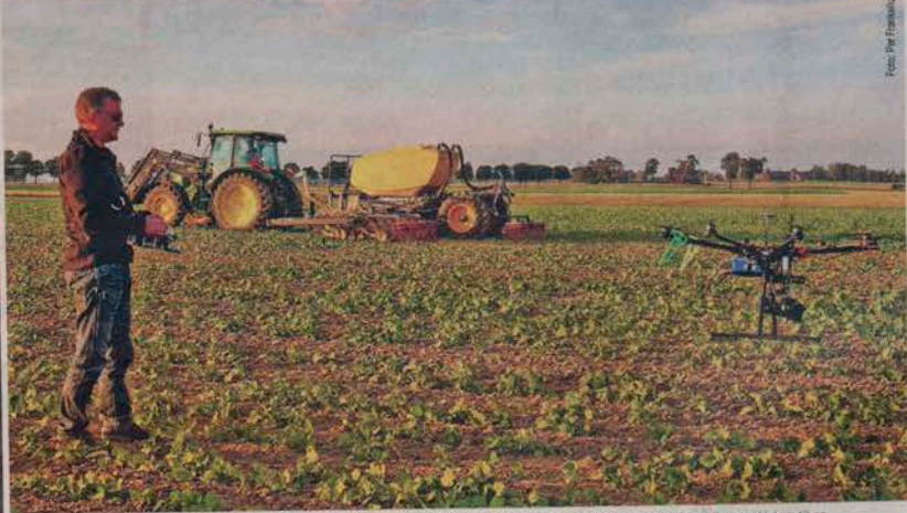
Med en sådan här drönare läser med hjälp av sensorer och RTK-GPS av fältet och kan identifiera enskilda ogräs. Informationen skickas till en markrobot som tvekar ut och bekämpar just det ogräset.
